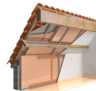
Schéma de pose autoportante
