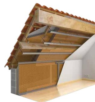
Schéma de pose avec suspentes
